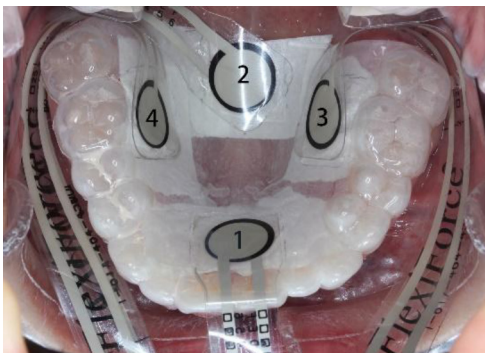
Рис. 1. Внутрішньоротове вимірювання тиску язика на індивідуальній вакуумній накладці
